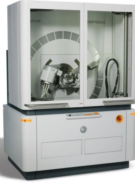
Şekil 3.3. ÇÜMERLAB' da PANalytical marka EMPYREAN XRD model XRD cihazı
