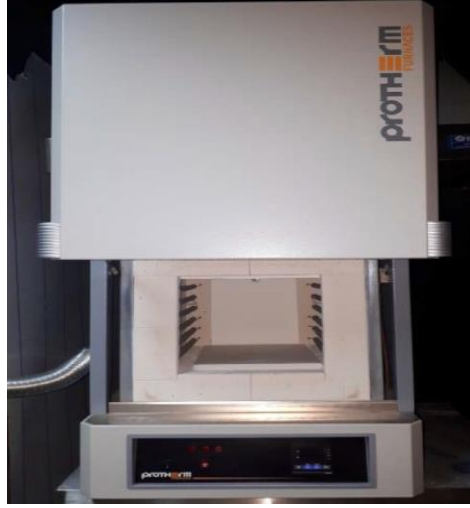
Şekil 3.6. Isıl işlem için kullanılan Protherm marka fırın
