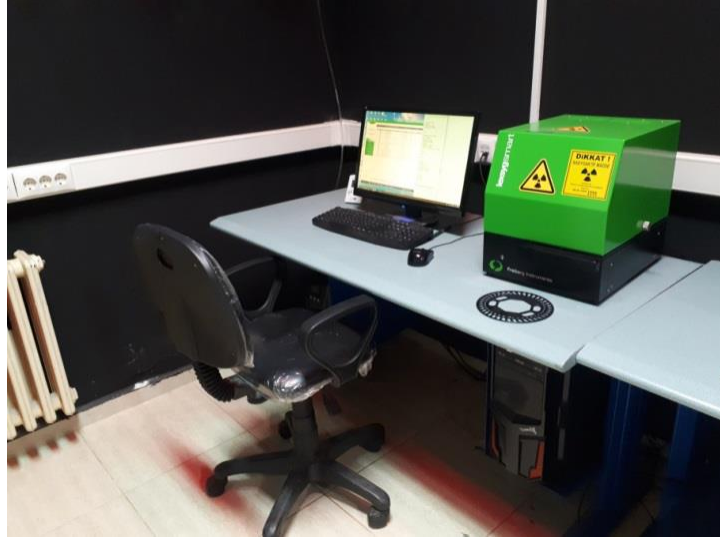
Şekil 3.7. Lexsyg Smart TL/OSL okuyucu cihazı
