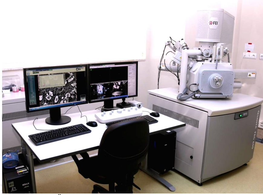
Şekil 3.2. ÇÜMERLAB' da Quanta 650 Field Emission SEM cihazı
