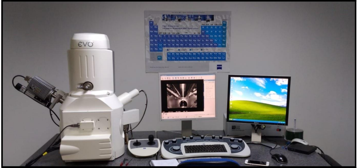
Şekil 3.6. Ankara Üniversitesi Nükleer Bilimler Enstitüsünde bulunan Zeiss Evo 40 elektron mikroskobu
