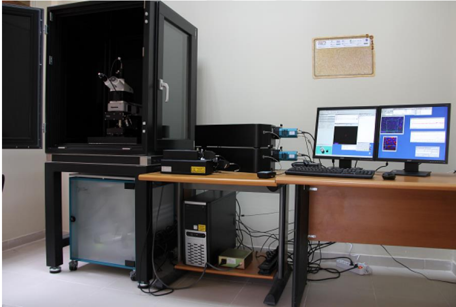
Şekil 3.4. Çanakkale Onsekiz Mart Üniversitesi Bilim ve Teknoloji Uygulama ve Araştırma Merkezinde bulunan Raman Spektrometresi ölçüm cihaz sistemi
