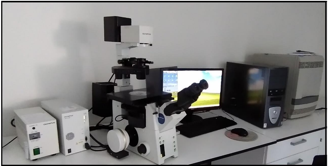
Şekil 3.2. Akdeniz Üniversitesi Gıda Laboratuvarı'nda bulunan ve Vinales meteoritini fotoğraflamak için kullanılan IX81 Olympus marka floresans mikroskop
