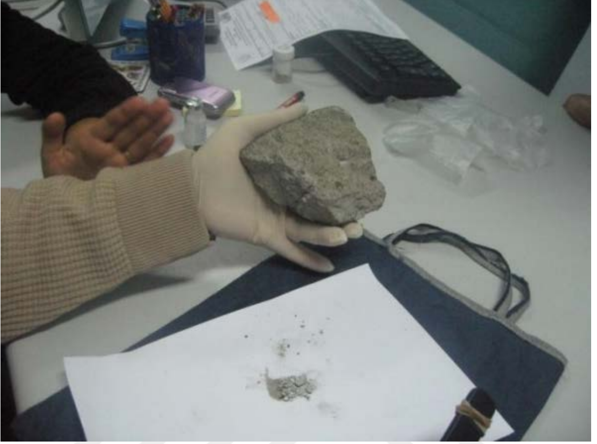
Şekil 4.7: Çanakkale göktaşından XRF cihazı (üstte) analizi için toz parçacıkları (altta) alındı.
